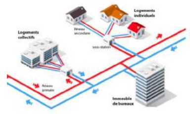
Réseau de chaleur
