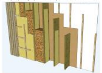
PRINCIPE MUR OSSATURE BOIS ISOLATION PAILLE
