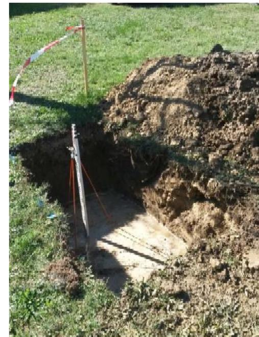
*Essais de perméabilité in situ*
