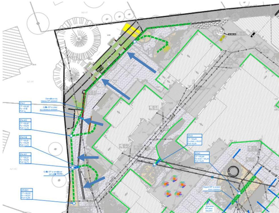
Les eaux pluviales cheminent sur les revêtements imperméables (toiture / revêtement de sol des cours) jusqu'au zone d'infiltration (zone en copeau de bois).
