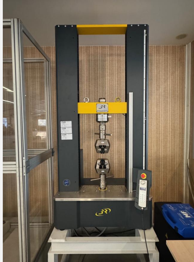
Machine pour essai Traction
