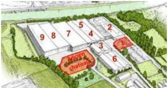
Vue d'ensemble du site à déconstruire – les bâtiments métalliques sont les 4,5,6,7,8 et 9
