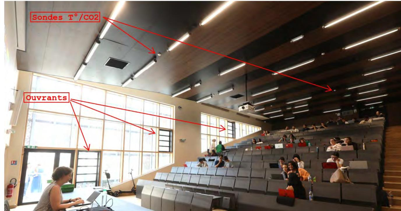
Point d'attention: La problématique des défauts de position qui remontent sur la centrale SSI en fonctionnement Ventilation naturelle Vs Désenfumage
