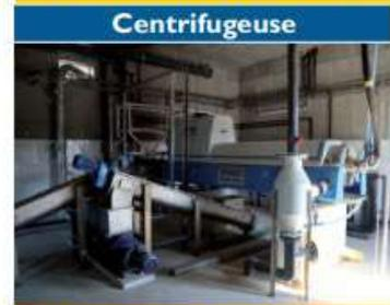
Séparation des phases solides (boues) et liquides (eaux) par centrifugation
