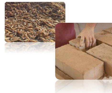
L'isolation des parois mitoyennes par la balle de riz, un matériau dense, réduit d'environ 60h la durée d'inconfort dans les logements concernés.
