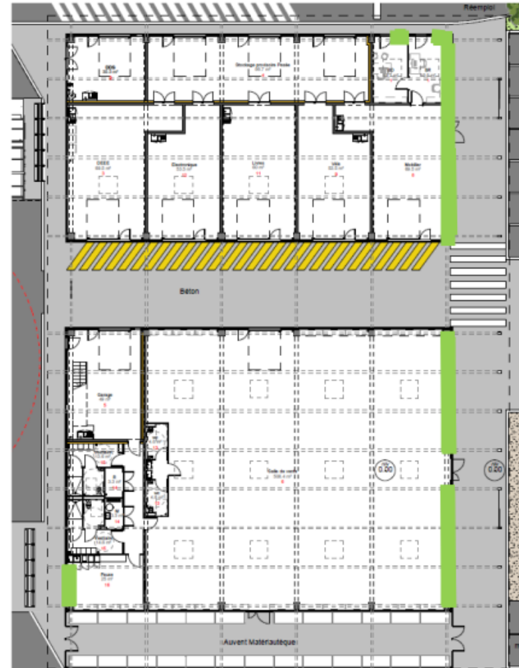
Plan de repérage des stores intérieurs (surlignés en trait vert) et casquettes (en pointillé)
