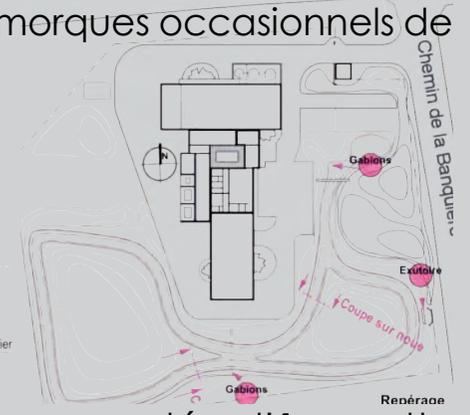
L'altitude de l'évacuation des eaux du bassin (contrôle par vanne martelière) est augmentée d'1m: cette réhausse permet un plus grand stockage d'eau pour l'infiltration, tout en conservant une marge conséquente avant l'exutoire 1) de contrôle ou 2) d'urgence au sud du bassin.
