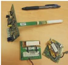
Photographie de 3 capteurs de  $\text{CO}_2$  montrant leur niveau d'intégration par micro technologies. Ce niveau d'intégration explique la fiabilité et la reproductibilité des capteurs, ainsi que la diminution de leur prix.
