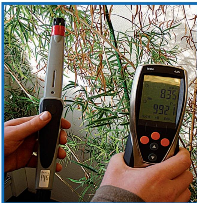
Enregistreur nomade pouvant mesurer l'humidité, le CO<sub>2</sub> et la température de l'air.
