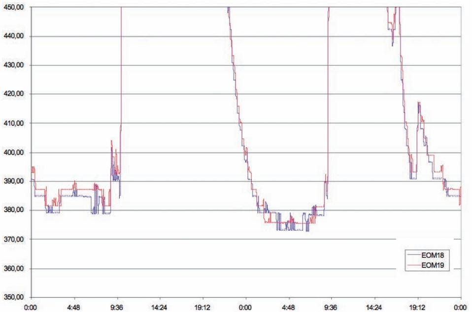
Mesure de  $\text{CO}_2$  après une purge de la salle, par deux capteurs. Dans ce cas, on obtient le palier correspondant à l'atmosphère extérieure, 8 heures après la désertion de la salle, avec un taux de renouvellement d'air de 3 Vol/heure.
