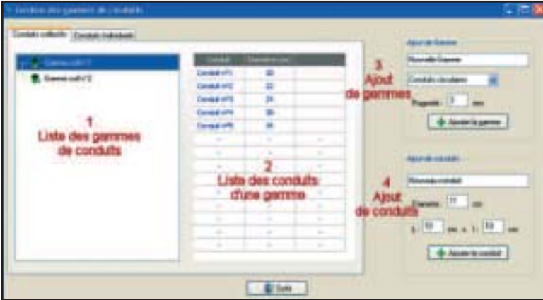
Figure 8.9 : gestion des gammes de conduits
