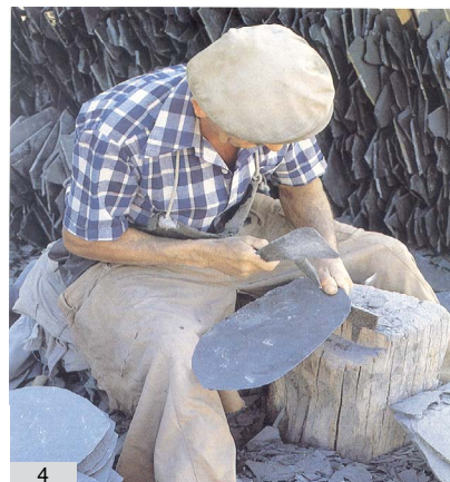
3. Après extraction, les blocs de schiste sont fendus en plaques minces de 12 à 15 mm.
