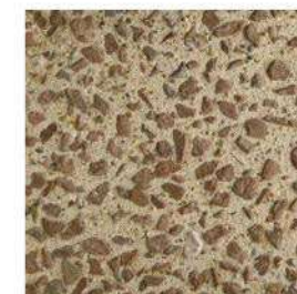
01 - Béton bouchardé avec agrégats coordonnés teinte de la pierre du site
