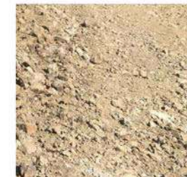
02 - Remblai terrasses arrière + Est constitué de déblais concassés sur site
