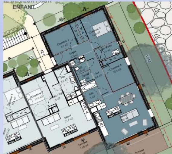
Logement transformable avec 2 SDB
