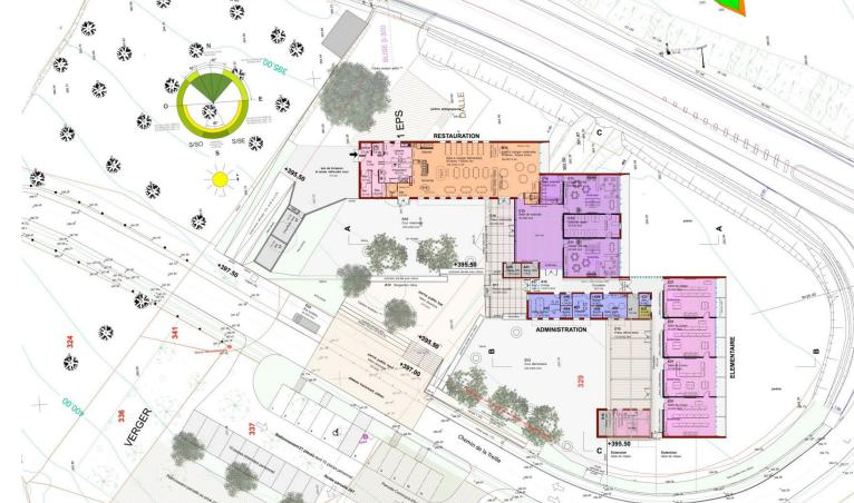
Ce plan développé en forme de M, permet de construire deux ailes autour de chaque cour de récréation, assurant une protection contre les vents froids du nord. Les préaux à l'extrémité Est de chaque cour sont ainsi idéalement protégés. Les deux cours sont orientées plein sud, leur permettant de bénéficier de l'ensoleillement toute la journée, depuis la récréation du matin aux fins d'après-midis périscolaires.
