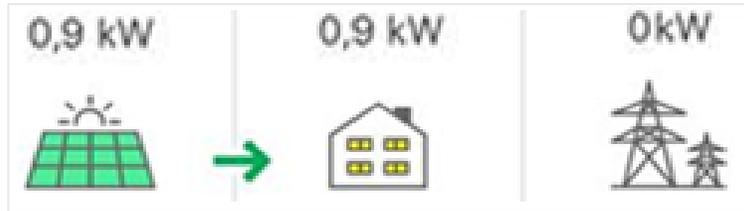
**production > consommation** : *Lorsque le ballon est chaud; réinjection du surplus sur le réseau (racheté 10cts€/kWh).*
