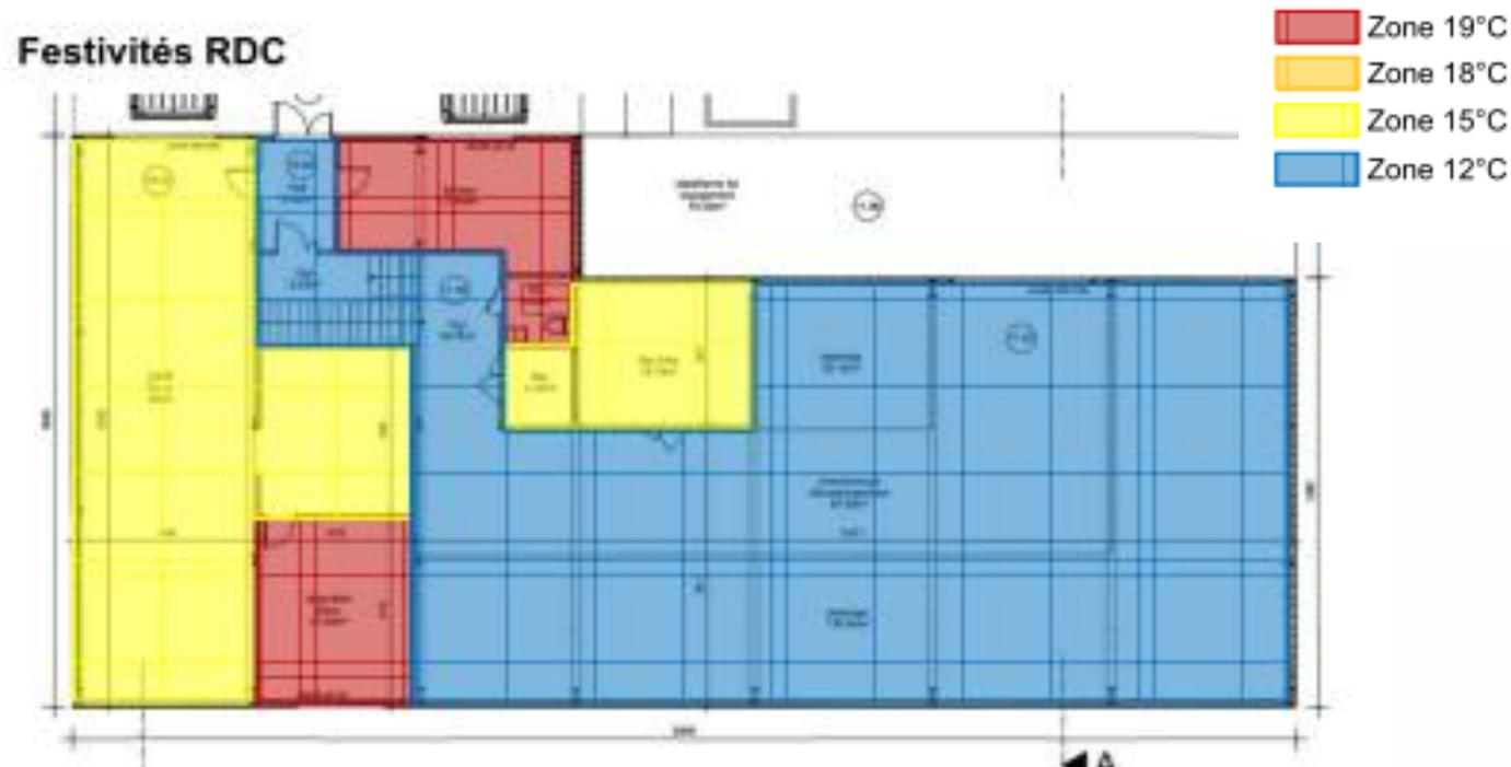
**Travail réalisé permettant d'optimiser le zonage thermique :** zone chauffée pour les bureaux et zone non chauffée pour les ateliers et les stockages.
