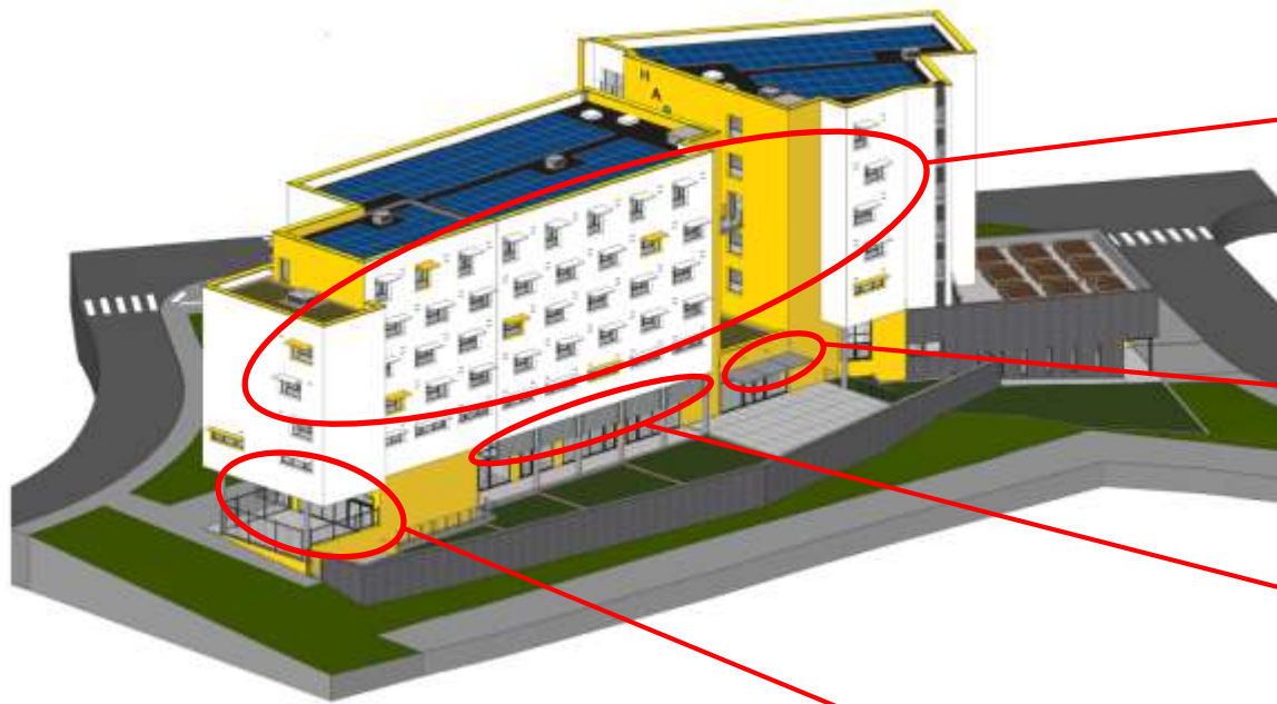
Vitrages à contrôle solaire Sur local à l'OUEST et sur les portes des circulations EST et OUEST
